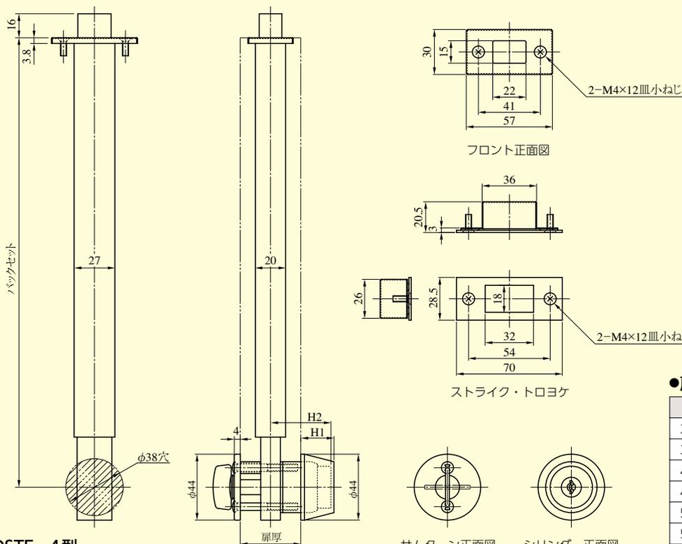
●扉厚によるH<sub>1</sub>、H<sub>2</sub>寸法(単位mm)
